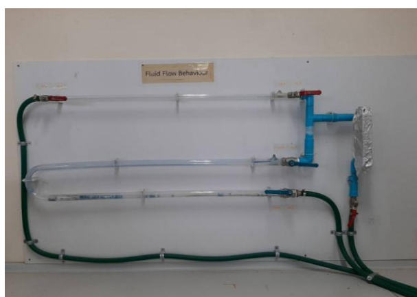
ภาพที่ 7.2.4 ชุดเครื่องมือสำหรับศึกษาพฤติกรรมการไหลและความเสียดทานภายในท่อ
