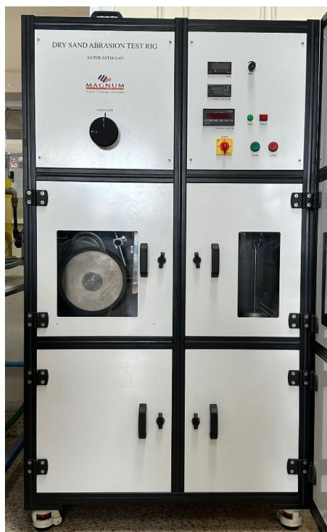
ภาพที่ 7.2.3 ชุดทดสอบการสึกหรอของวัสดุทางการเกษตรและพลังงาน
