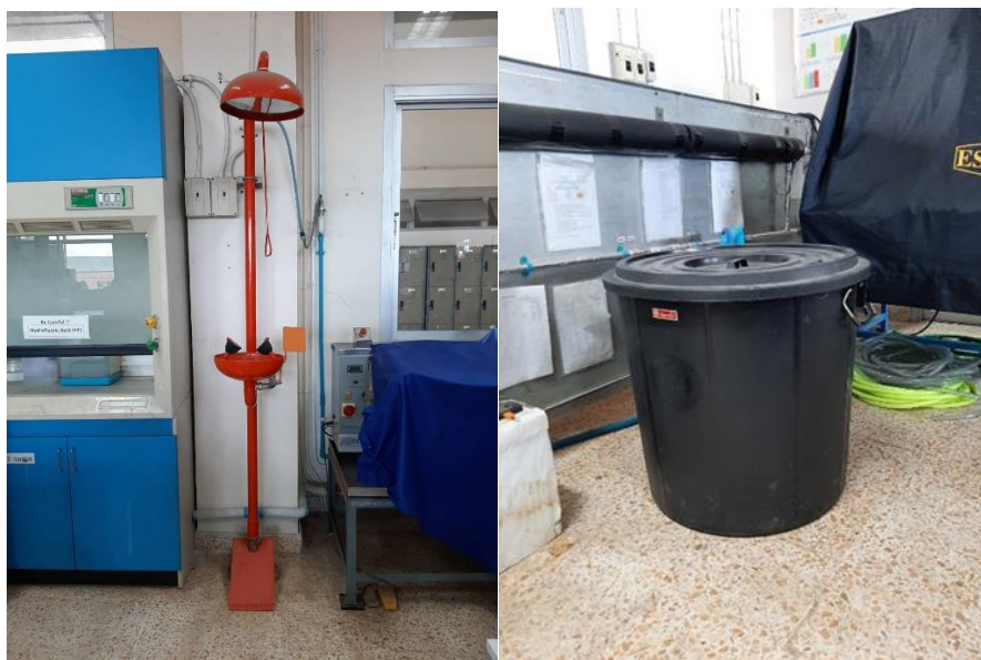
ภาพที่ 7.6.6 ชุดผักบัวและอ่างล้างตาฉุกเฉินภายในห้องปฏิบัติการ
