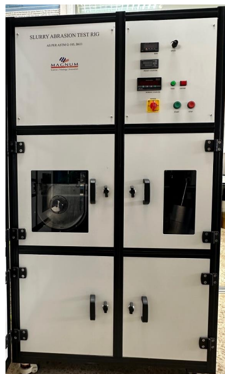
ภาพที่ 7.2.3 ชุดทดสอบการสึกหรอของวัสดุทางการเกษตรและพลังงาน
