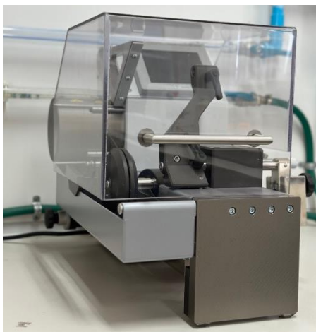
ภาพที่ 7.2.2 ชุดตัดตัวอย่างความแม่นยำสูงแบบ wire saw
