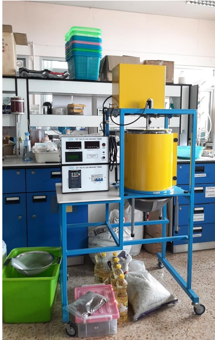
ภาพที่ 7.2.3 ชุดศึกษาการผสมและการแยกอนุภาคในระบบของไหล
