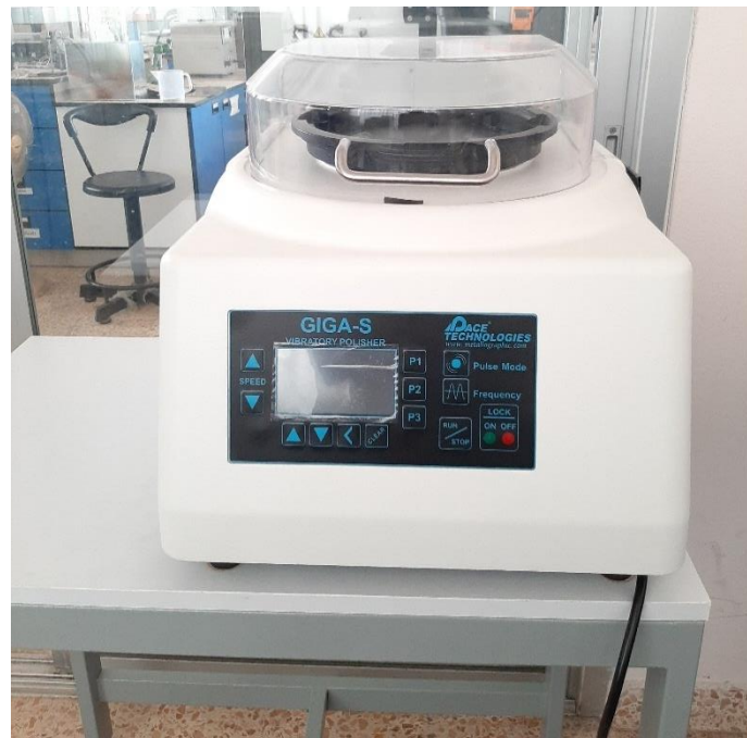
ภาพที่ 7.2.2 ชุดขัดผิวชิ้นงานความละเอียดสูงด้วยการสั่น
