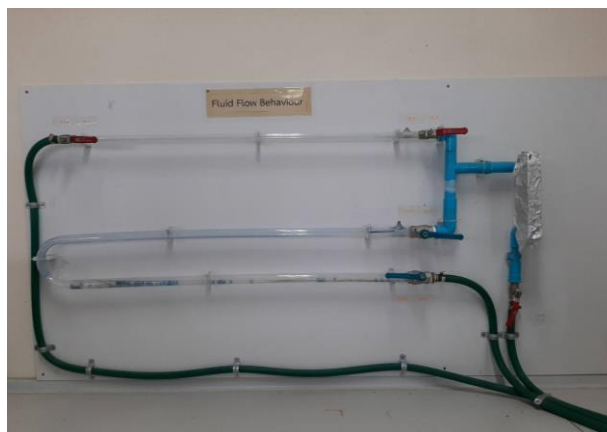
ภาพที่ 7.2.5 ชุดเครื่องมือสำหรับศึกษาพฤติกรรมการไหลและความเสียดทานภายในท่อ
